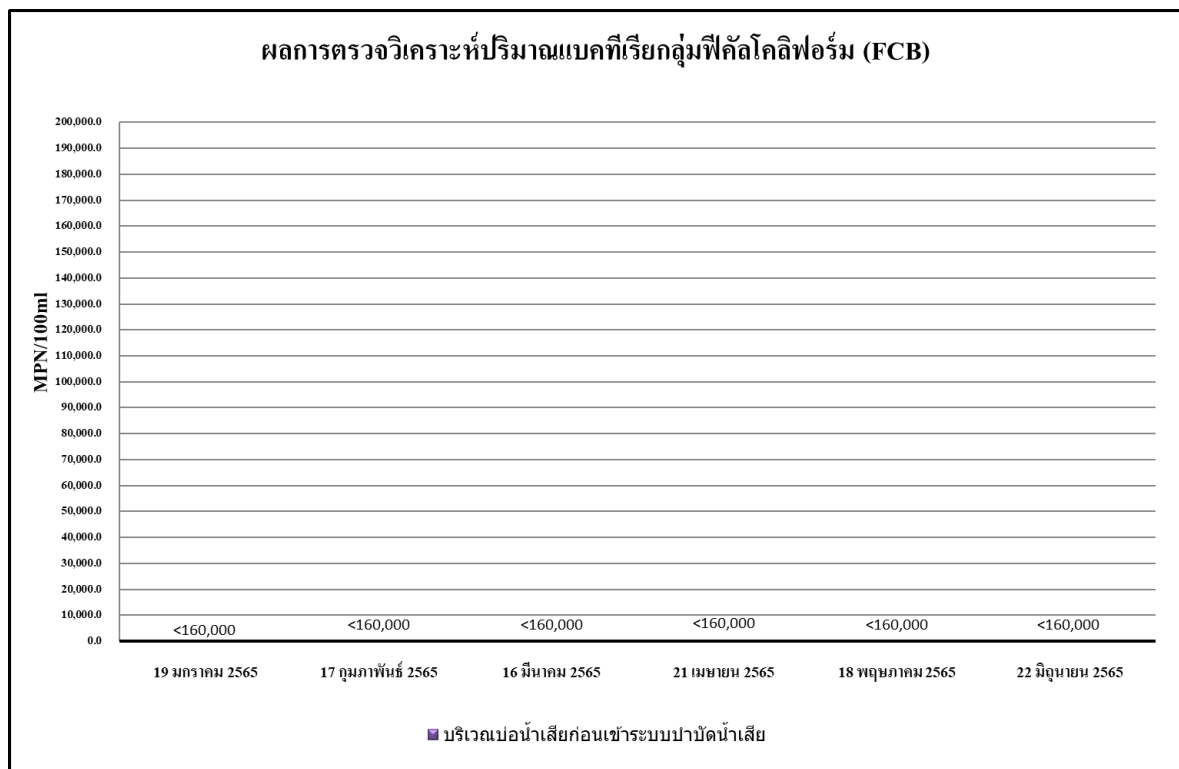
รูปที่ 4.4-12 ผลการวิเคราะห์ปริมาณแบคทีเรียกลุ่มฟีคัลโคลิฟอร์ม (FCB) บริเวณบ่อน้ำเสียก่อนเข้าระบบบำบัดน้ำเสีย ระหว่างเดือนมกราคม-มิถุนายน 2565
